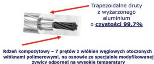
Rys. 1. Budowa przewodu ACMCC® Fig. 1. ACMCC® conductor construction
