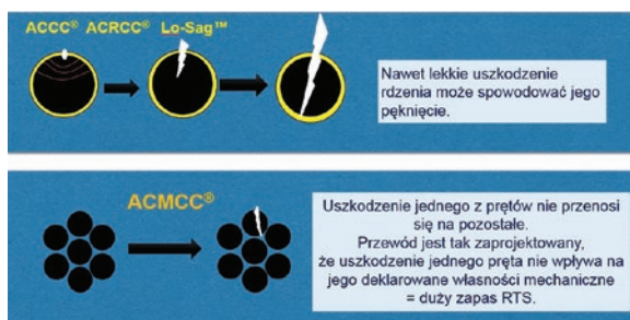
Rys. 8. ACMCC® jest odporniejszy na pęknięcie Fig. 8. ACMCC® is much more resistant to cracking
